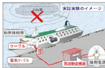
苫小牧港で陸送電実証実験(同)
