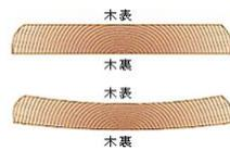
そこで、角材の木表側の中心部に凹型の溝を掘って、木表側を貼り合せると、角材の柱に「中空」＝空気層ができます（右図参照）。
