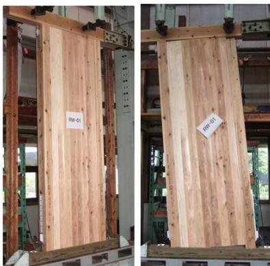
【写真説明】左が「列柱壁」の基本型。右は最大の荷重をかけたときのものです。傾いてもバラけることもなく、柱が抜ける懸念も払拭されました。
